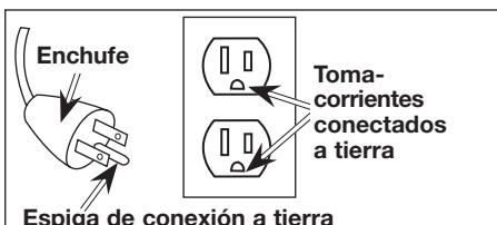
**▲PELIGRO:** Riesgo de choque eléctrico. LA CONEXIÓN INADECUADA A TIERRA PUEDE CAUSAR UNA DESCARGA ELÉCTRICA.
